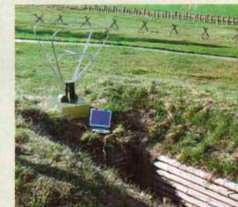
Станция помех радиовзрывателям артиллерийских снарядов СПР-3 SPR-3 Artillery Ammunition Radio Fuze Jammer Set
