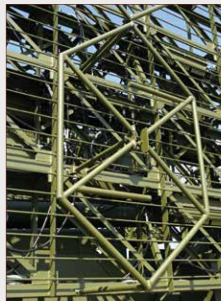
▲ Zespół antenowy AS-14M drugiego prototypu radaru – Wostok-D (po lewej) i zbliżenie na zespoły dipoli jednostki antenowej AS-14M (po prawej).
