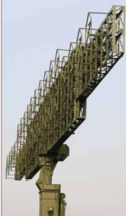
▲ Zespół antenowy AS-14M drugiego prototypu radaru – Wostok-D (po lewej) i zbliżenie na zespoły dipoli jednostki antenowej AS-14M (po prawej).
