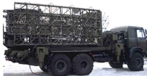
РЛС «Восток» метрового диапазона в транспортном положении. Время свертывания-развертывания РЛС расчетом из двух человек не превышает 10 минут.
