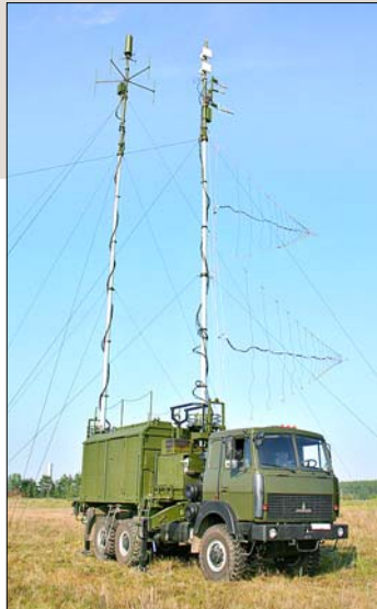
Станция помех УКВ радиосвязи «Гроза».
