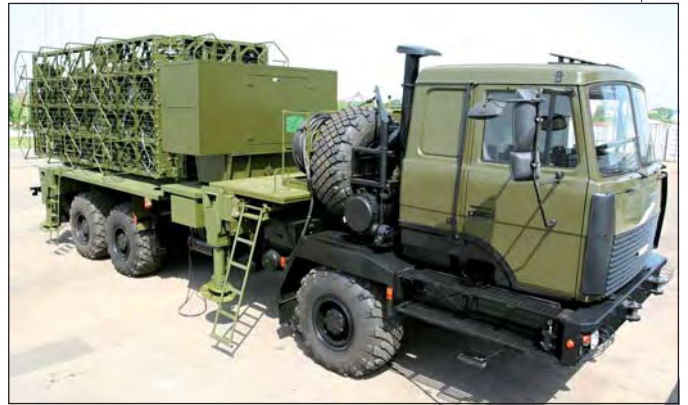
■ Radar Vostok-D v pochodovej polohe so zloženou anténovou jednotkou i jej nosným ramenom
