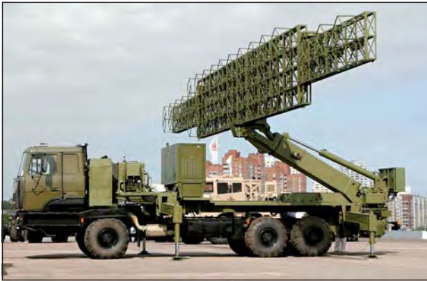
■ Rozvinovanie radaru Vostok-D. Anténová jednotka AS-14M je už zložená. Teleskopické nosné rameno sa hydraulicky zdvíha do pracovnej polohy.
